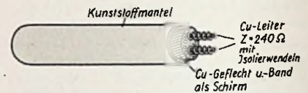
Abb. 23. Symmetrische Rundkabel mit Wellenwiderstand Z = 240 \text{ Ohm}
