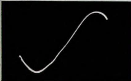
Abb. 8. Diskriminator-Kurve bei ausreichend starken Signalen
