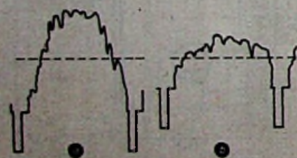
Abb. 15. Spannungsverlauf für volle (a) und geringe (b) Bildmodulation
